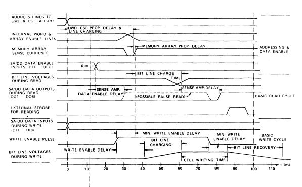
Figure 14—Timing diagram - 8192 bit MOS stack memory
